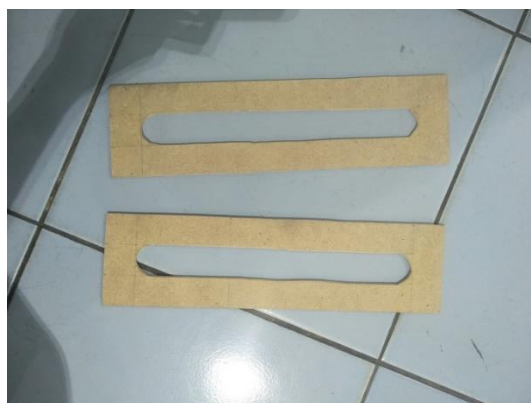
5. นำไม้ขนาด 11 x 3 ตารางนิ้ว 2 ชั้น มาเจาะรูตรงกลางดังภาพ
